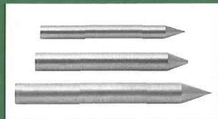
Et on obtient des électrodes parfaitement affûtées et coupées
