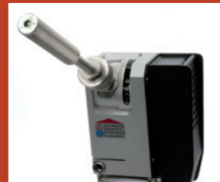
Angle de meulage réglable de 15-180° (angle inclus).
