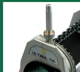
Faire un plat à la pointe de l'électrode tungstène dans la position 90 degrés. 1 Point à la vis de vernier représente 0,1 mm diamètre de surface.
