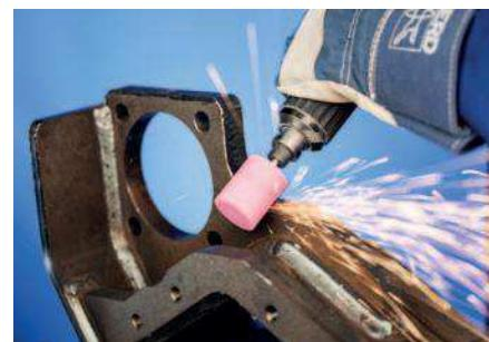
Les meules sur tige de **dureté O** sont fabriquées à base d'un liant céramique et de corindon supérieur rose. Grâce à la combinaison entre les grains très résistants à l'usure et au liant dur, ces meules sur tige présentent une durée de vie très élevée et un bon volume d'enlèvement par unité de temps. La dureté O convient particulièrement à une utilisation dans les angles et aux travaux d'ébarbage sur les ouvrages en acier.
