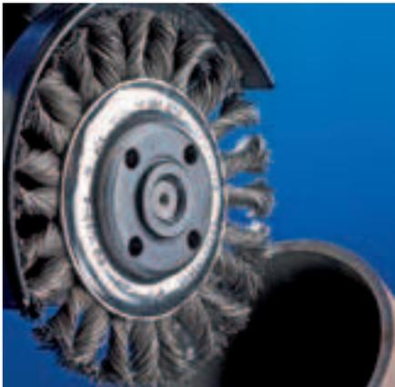
Pour les travaux de brossage contraignants en menuiserie métallique par ex. décalaminage, dérouillage, nettoyage des cordons de soudure, élimination des résidus de colle. En comparaison avec les fils ondulés, les fils torsadés assurent un brossage plus agressif.
