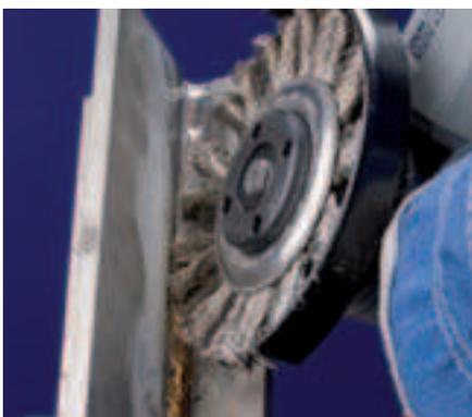
Convient au brossage à contraintes élevées, comme le décalaminage, le dérouillage, l'ébavurage et le nettoyage des cordons de soudure. L'exécution mince RBGIT PIPE de la brosse convient parfaitement au brossage des endroits difficilement accessibles, tels que par ex. la première passe après soudage.
