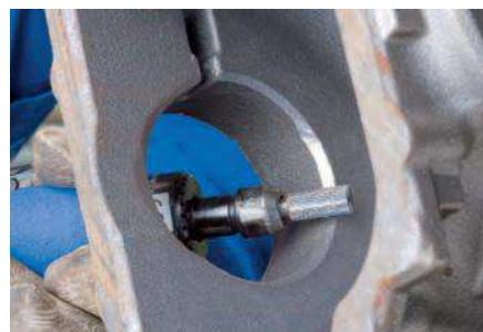
Fraise sur tige cylindrique selon DIN 8032 avec denture selon DIN 8033. Forme ZYAS avec denture en périphérie et en bout.
