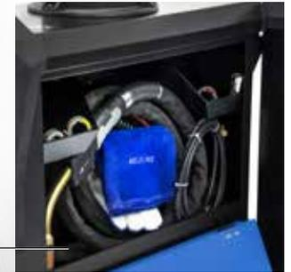
**Pratique, grande caisse de rangement à l'intérieur de la machine** avec serrure à clé, pour les accessoires tels que torche, gants, galets, tubes contact, etc. de contact, etc.
