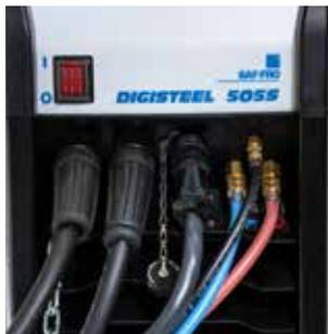
**Dispositif de raccordement du faisceau**
