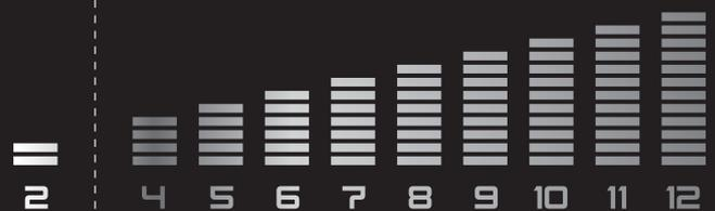
La régulation adaptative du niveau de protection règle de manière entièrement automatique le niveau de protection approprié dans la plage de 4 à 12. Cette tâche revient à un capteur de luminosité supplémentaire qui mesure l'intensité de l'arc électrique. Vous restez ainsi toujours parfaitement protégé, et ce quels que soient vos paramètres de soudage momentanés. Les adaptations manuelles ne sont plus nécessaires.
