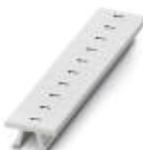
Repérage ZB, Rubans, blanc, repéré, repérable avec : CMS-P1-PLOTTER, impression longitudinale: chiffres identiques 1 ou 2, etc. jusqu'à 100, type de montage: encliquetage dans la rainure de repérage élevée, pour bloc de jonction au pas de : 5,2 mm, surface utile: 5,15 x 10,5 mm
