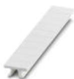
Repérage ZB, Rubans, blanc, vierge, repérable avec : PLOTMARK, CMS-P1-PLOTTER, type de montage: encliquetage dans la rainure de repérage élevée, pour bloc de jonction au pas de : 5,2 mm, surface utile: 5,1 x 10,5 mm
